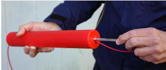
3. Anschließend stecken Sie den Zünder in die Zünderaufnahme neben der zentralen Bohrung.
