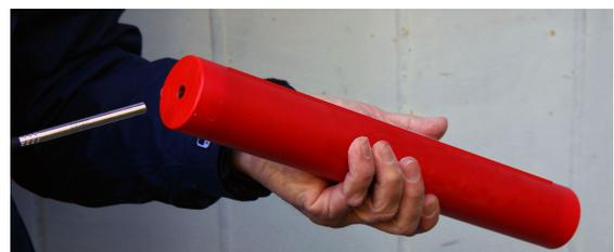
1. Schieben Sie den Zünder von oben durch die zentrale Bohrung des Zündverstärkers und ...
