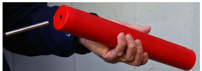
1. Schieben Sie den Zünder von oben durch die zentrale Bohrung des Zündverstärkers und ...
