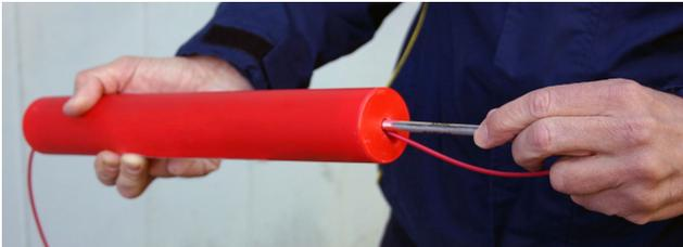
3. Anschließend stecken Sie den Zünder, vollständig und bis zum Anschlag, in die Zünderaufnahme neben der zentralen Bohrung.
